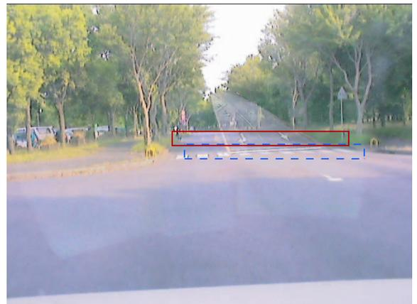
Figure 17: ランドマークの車載カメラ画像への投影
