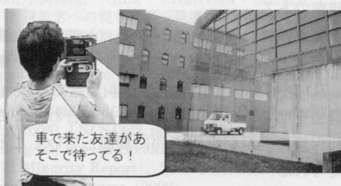
携帯型情報端末をシースルーしたい方向にかざすと、建物の死角になっている部分が可視化されて、あたかも障害物である建物を透視しているかのような映像が情報端末のディスプレイに提示される
