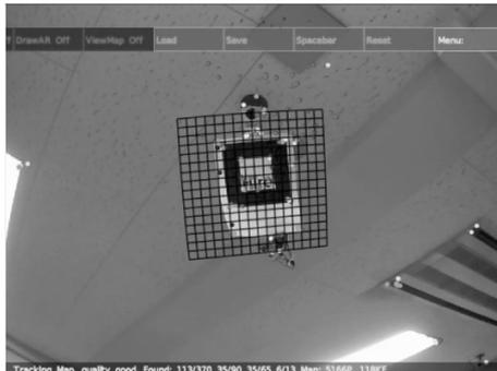
図6 マーカーを用いて3Dマップの初期化を行った際に決定された座標平面
