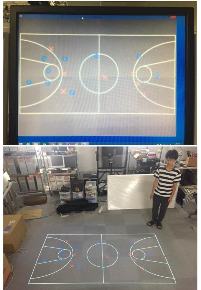
図 6 開発したユーザインタフェース：(上) ユーザ入力画面、(下) ユーザに提示される投影コンテンツ
