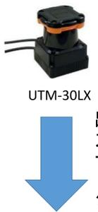
測域センサ(Laser Range Scanner)は空間の物理的な形状データを出力することができる走査型の光波距離計
