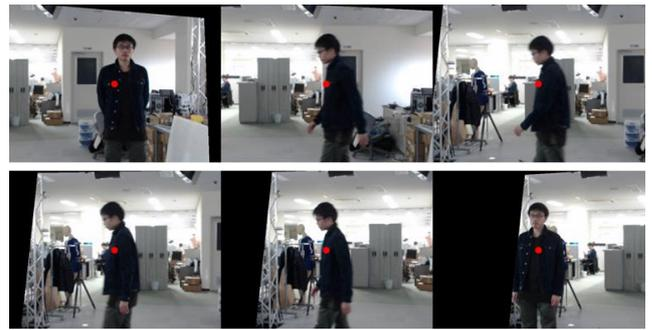
図4 被写体追跡 (1段目の左の立ち位置から、2段目の右の立ち位置へと移動している。赤丸は注視点)
