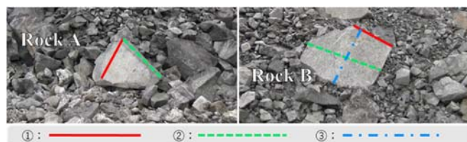
図6 3次元モデルの復元精度検証に用いた岩Aと岩Bの各計測箇所
