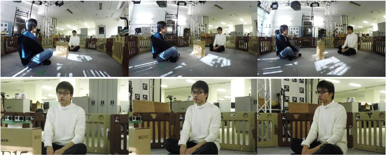
図3. Outside-In カメラの注視点設定処理（上：元画像，下：処理後画像）
