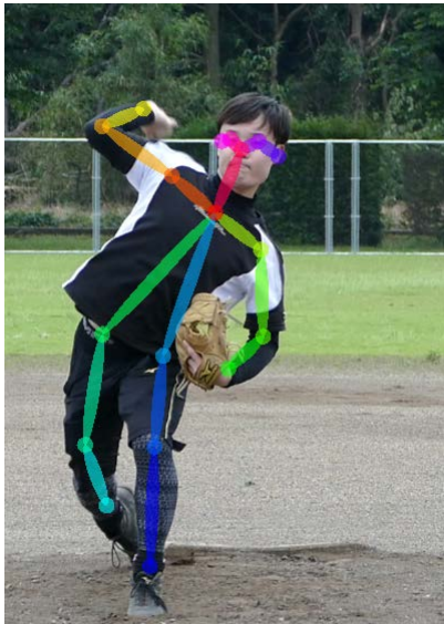
図 4 : OpenPose による投手の骨格位置推定結果 (左 : 意識せず投球した場合, 右 : 意識的に肘を下げた場合)
