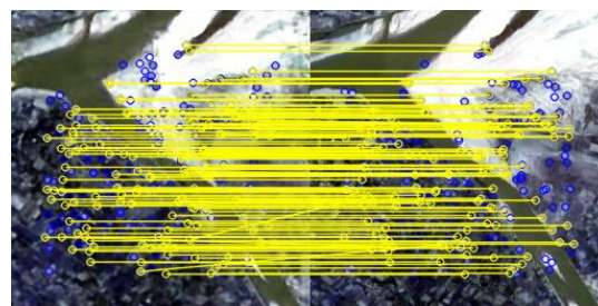
図 4 二画像の対応点探索の例。各黄色の線は対応点を、青い点は対応点がないことを意味する。
